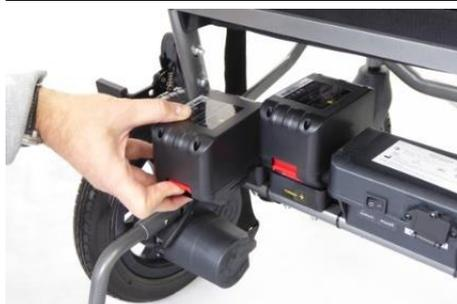
Les piles peuvent être retirées en appuyant sur la languette rouge vers le haut et en tirant vers l'arrière.
